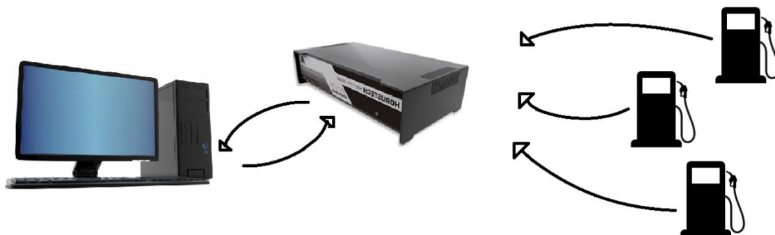
Figura 1 – Comunicação entre Computador x Horustech x Bombas
